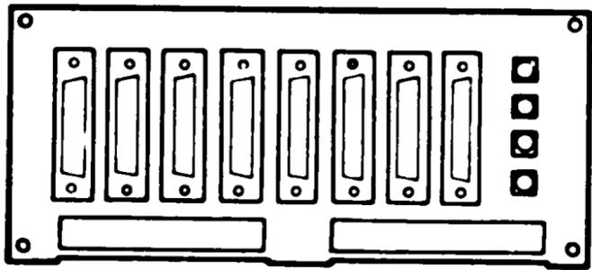
COMPONENT SIDE OF CONNECTOR BOARD
