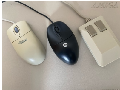
Von links nach rechts: PS/2 Kugelmaus, PS/2 Optische Maus und die 9-Pin Tank Maus von Commodore.
