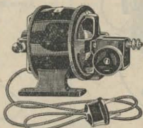
Elektrisk motor N o 2338, med stomme av gjutjärn, stabil och kraftig konstruktion. Försedd med talet från 3000 till 300. Med 4 remskivor i olika storlekar. Vikt 2,1 kg. Vid order uppgiv önskad
